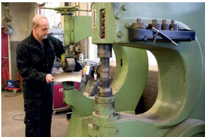
Met een Engels wiel (vooraan) en een Eckold krimp en rek machine plus Lensink's jarenlange ervaring in plaatwerken, is het mogelijk om elke vorm in het plaatwerk te maken. Toch valt het resultaat wel eens tegen. Lensink: "Dan zit er niets anders op dan het plaatwerk weggoien, thuis uithuilen en de volgende dag opnieuw beginnen".
