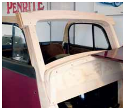
Hier is het houten frame van een DKW zichtbaar. Een houtbewerker heeft de ruwbouw gedaan, zodat het nu taak is om met zagen en schuren het hout op maat te krijgen. Een groot deel van het frame is bespannen met geïmpregneerd doek.
